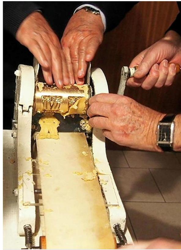
Der Teig wird durch die Trommel mit den Spekulatiusformen gedreht.
